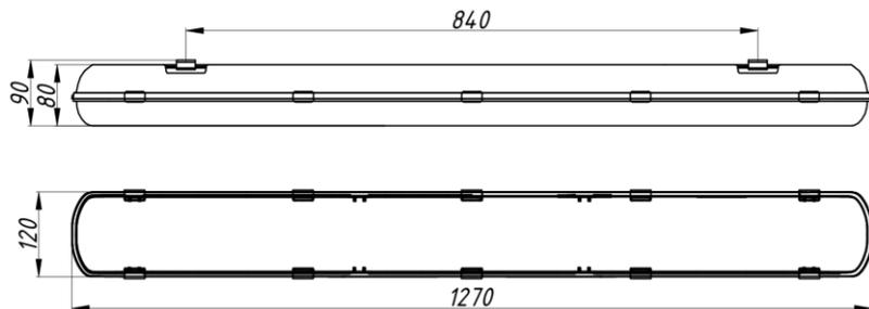
Рисунок 1 – Габаритные размеры светильника ЛСП 2х36.
